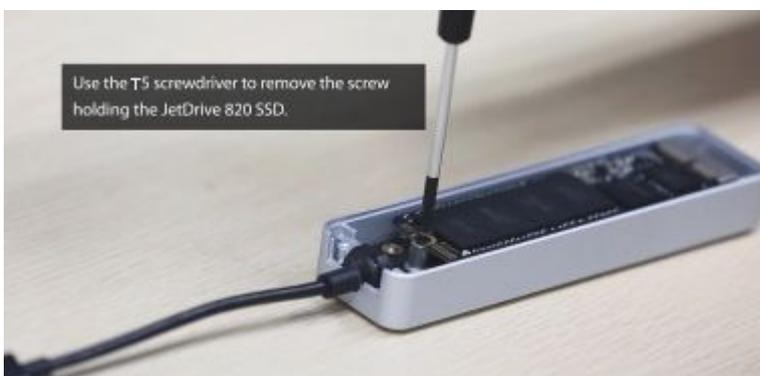
Use el destornillador T5 para retirar el tornillo que está fijando el SSD JetDrive.
