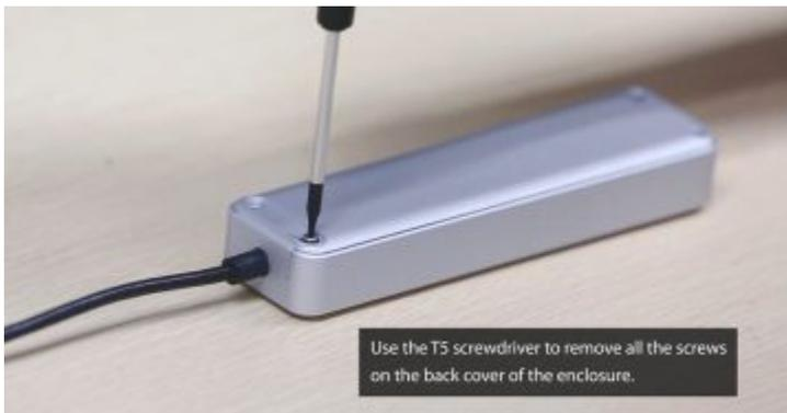
Use el destornillador T5 para extraer todos los tornillos de la parte trasera de la carcasa externa.
