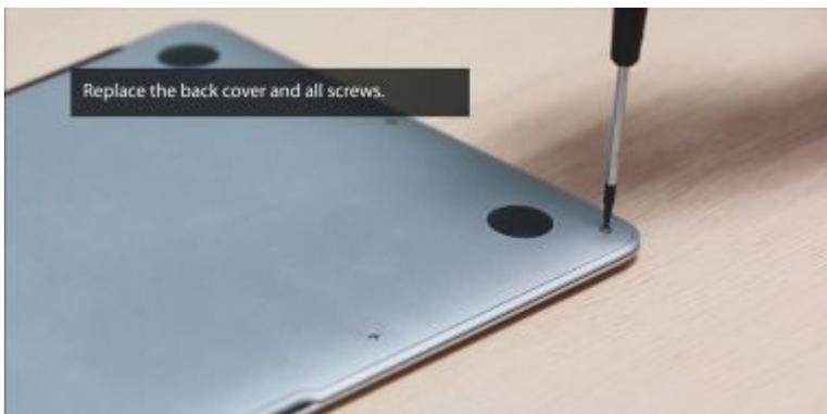
Vuelva a colocar los tornillos de la parte trasera del equipo.
