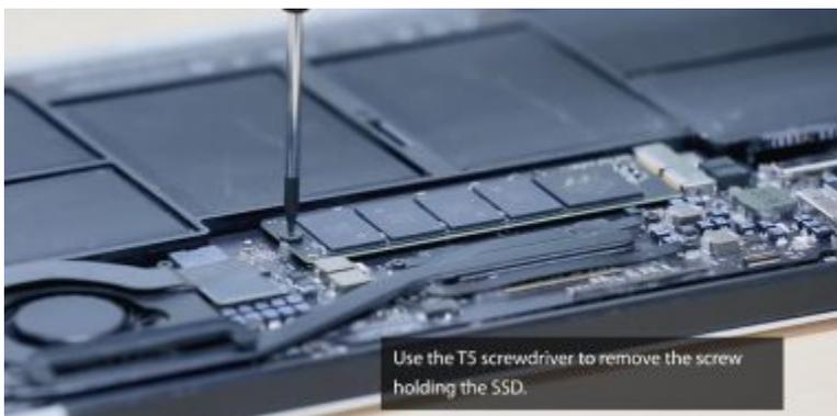
Use el destornillador T5 para retirar los tornillos que están fijando el SSD del equipo.
