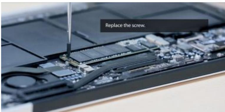
Vuelva a colocar los tornillos para fijar el SSD JetDrive en el equipo.
