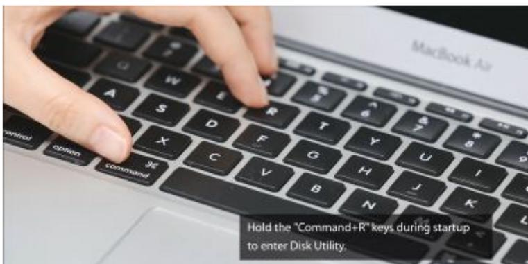
Presione las teclas "Command+R" durante el arranque para acceder a Disk Utility.
