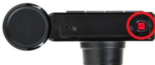
**手动紧急录像：**在录像过程中，请按 DrivePro 行车记录器底部的红色按钮，手动启动「紧急录像」模式。此时屏幕上会显示紧急录像警告图标。
