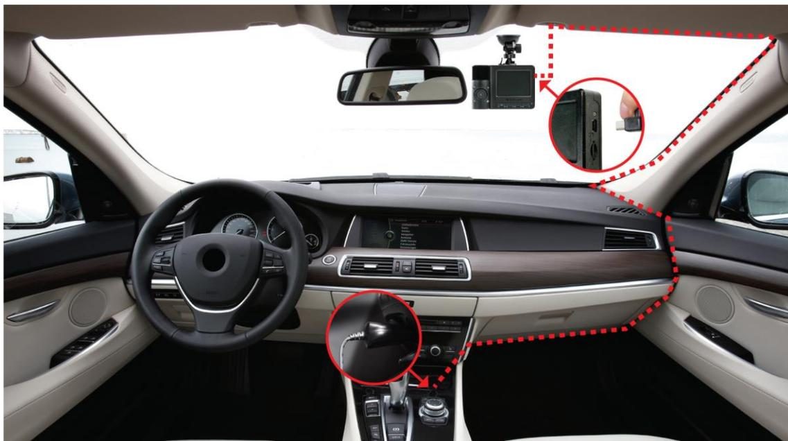
1. 将车用转接头的一端连接至 DrivePro 行车记录器的 mini USB 端口。
