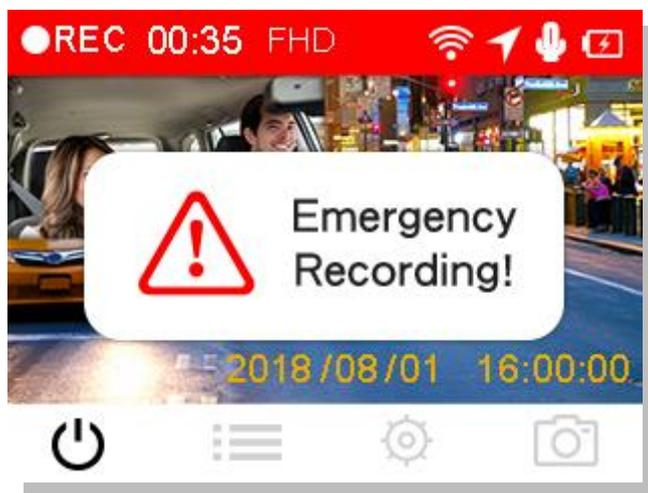
**自动紧急录像：**在录像过程中，DrivePro 行车记录器侦测到任何碰撞及冲击时，将会自动启动「紧急录像」模式。
