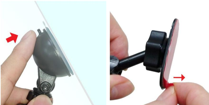
4. 将固定支架的环扣以逆时针方向转松，以调整 DrivePro 行车记录器位置。
