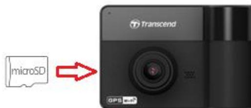
**注意：**开始使用 DrivePro 行车记录器前，请先将全新闪存卡格式化。欲格式化闪存卡，请压 DrivePro 机身上的设定键并选择**格式化**。
